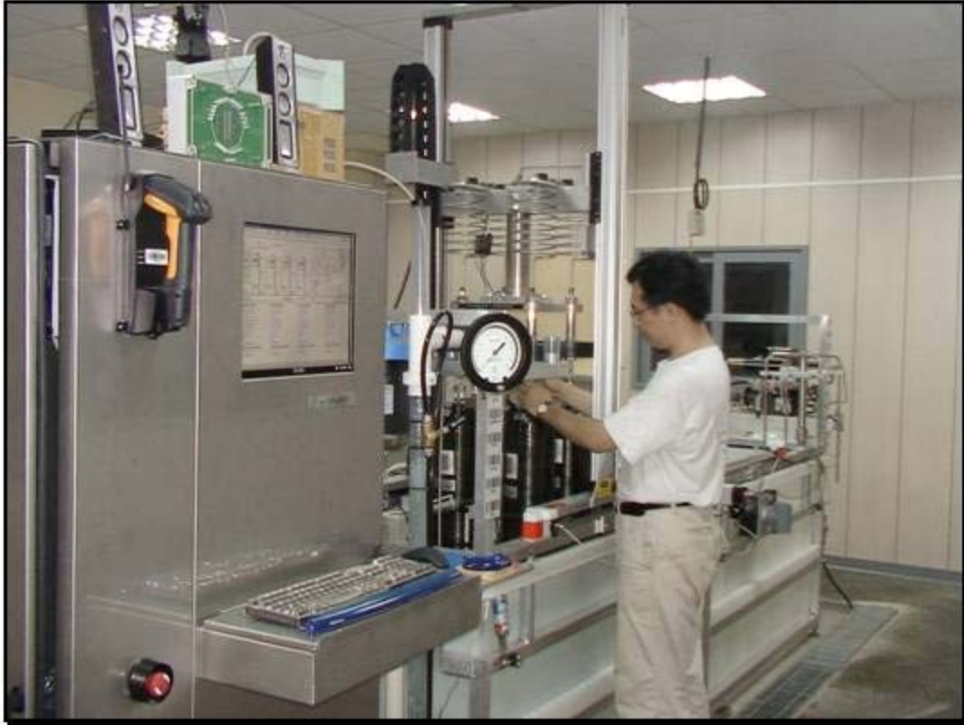
图片 22 Rec4 自动化 VHT 为小型综合气瓶 – Advanced Material Systems
