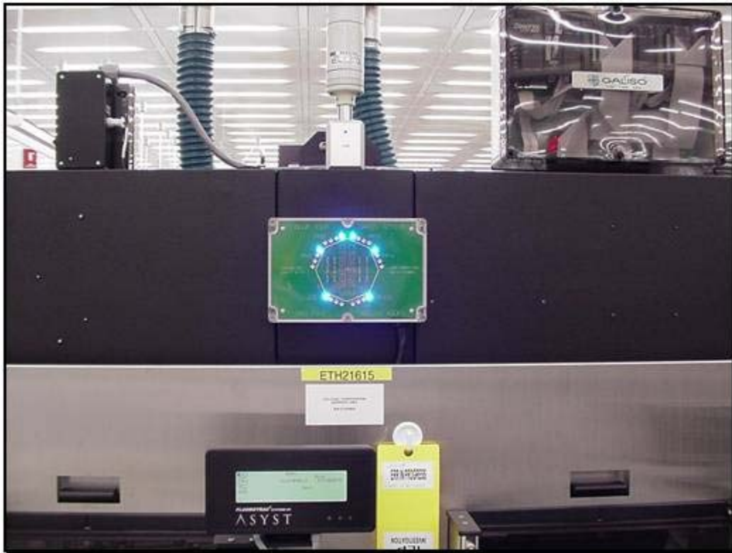
图片 12 Galiso 网络 PLC 控制系统近照为 Lam PTX Alliance
