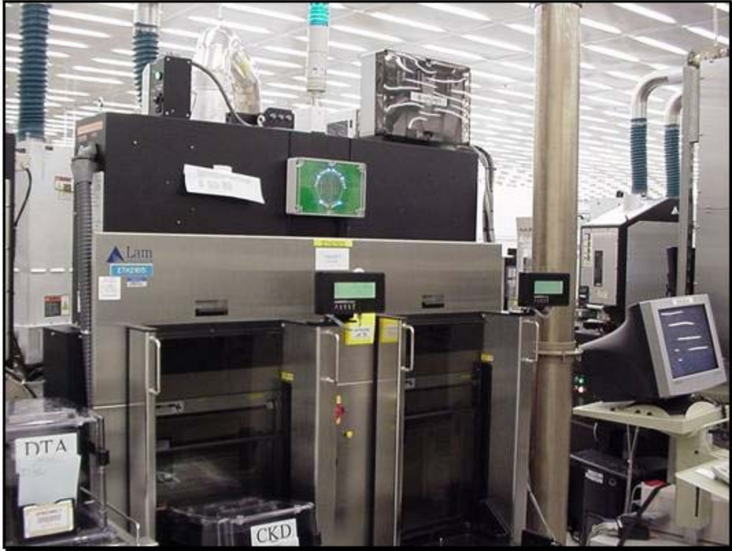
图片 11 Galiso 网络 PLC 控制系统为 Lam PTX Alliance
