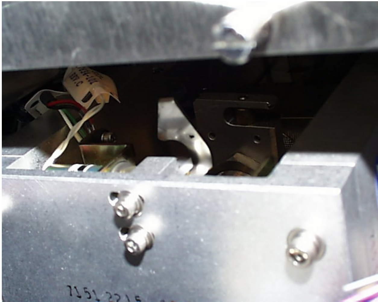
ELL Door Actuator Bend the actuator tab as shown
